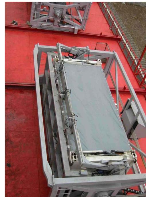
Разгрузка контейнеров производится полностью автоматизированной крановой установкой или грузовой машиной
